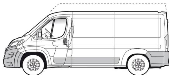
L2 | RADSTAND 3.450 mm | FAHRZEUGLÄNGE / FAHRZEUGBREITE: 5.413 / 2.050 mm
