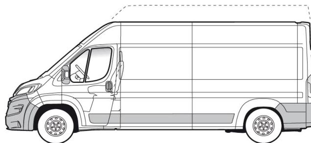
L3 | RADSTAND 4.035 mm | FAHRZEUGLÄNGE / FAHRZEUGBREITE: 5.998 / 2.050 mm
